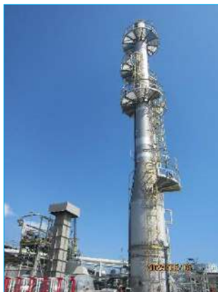
ภาพที่ 2-1 ระบบ Thermal Oxidizer
